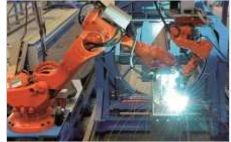
Vollautomatische Fertigung von Stahlkonstruktionen aus Recyclingträgern
