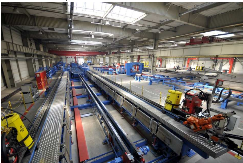
Produktionshalle mit Wellstegträger-Produktionslinie Production hangar with corrugated web beam production line
